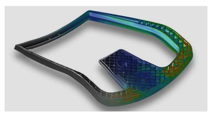
Belastungssimulation der Kunstoff-Rückenlehne (Berechnung nach der Finite-Elemente-Methode) Load simulation for the plastic backrest (Calculateion using the finite element method)
